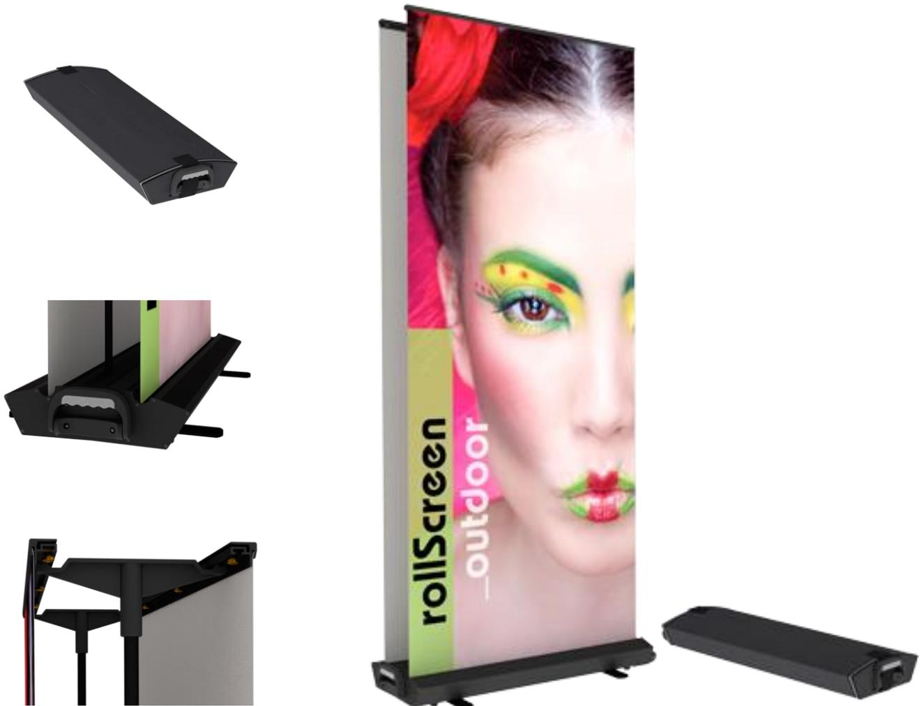
Roll screen\_outdoor ist ein Rolldisplay für den Außeneinsatz. Das System besteht aus schwarz eloxiertem Aluminium und ist ausschließlich als doppelseitiger Variante erhältlich. Es werden zwei 3-teilige Systemstangen benötigt. Die Systemkassette besitzt zwei Transportrollen inkl. Tragegriff. Um das nötige Gewicht für den Außeneinsatz zu erreichen ist in der Systembasis ein Stahlkern eingebettet. Zwei zusätzliche Standfüße zum Anschrauben erhöhen die Stabilität.
